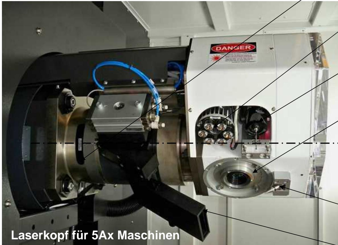
Laserkopf für 5Ax Maschinen
