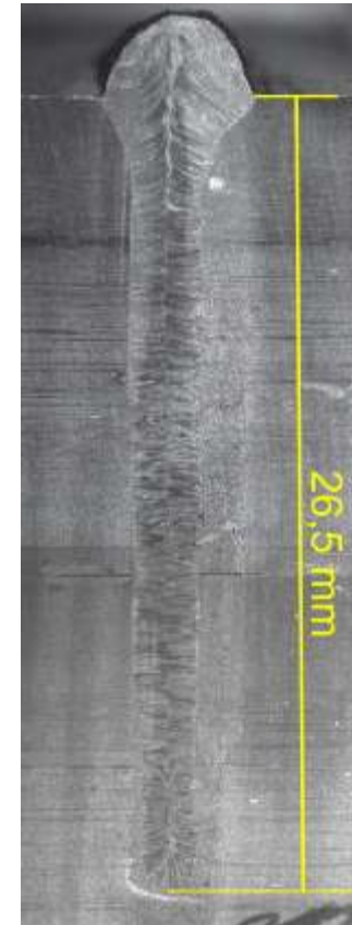
Überlappverbindung 2x 15 mm Edelstahl 1.4301
