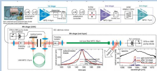
Ryser *et.al.*: 1064nm, 11ps, >10µJ, 1MHz
