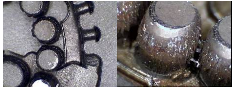
Laserabtrag mit ns-Laser
