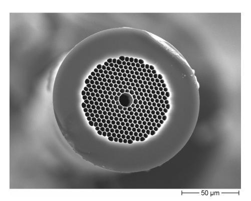
Realisation von Wellenlängennormalen mittels Gas gefüllten Hollow Core Photonic Crystal Fiber(HCPCF).
